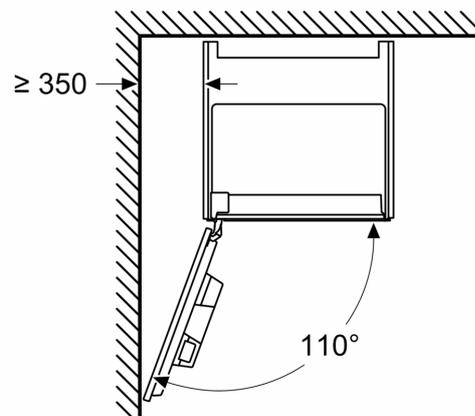
Bei Verwendung des 92°-Scharnierbegrenzers beträgt der min. Abstand zur Wand nur 100 mm
