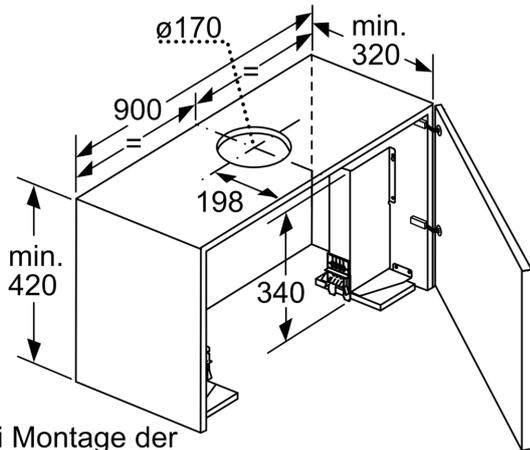
Bei Montage der 90cm Flachschildhaube in einen 90cm breiten Oberschrank ist ein Montage-Set erforderlich. Die beiden Montagewinkel werden rechts und links im Möbel verschraubt. Montage nach Schablone.
