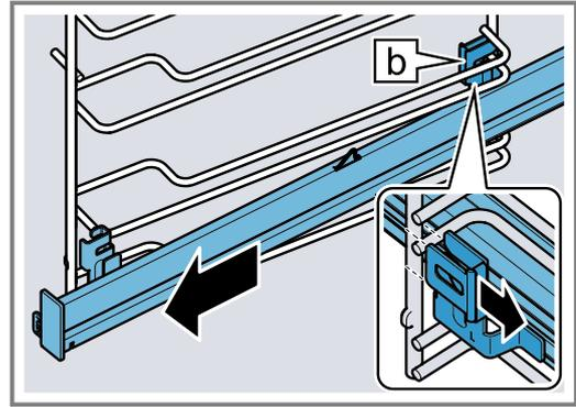
4. Die Auszugsschiene entfernen.
