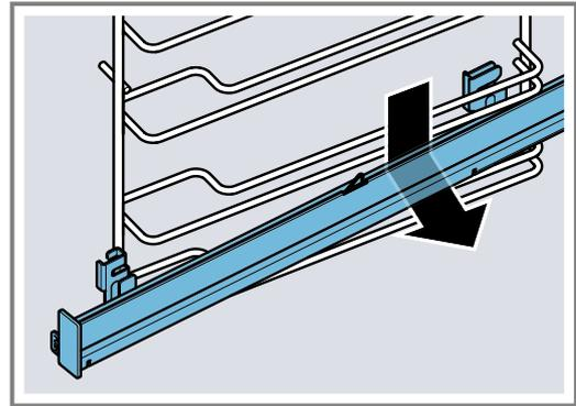
5. Die Auszugsschiene reinigen.
