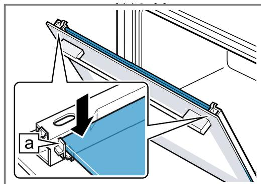
5. **Hinweis:** Achten sie beim Einschieben der Scheibe, dass die glänzende Seite der Scheibe außen ist und der Ausschnitt links und rechts oben ist. Die Innenscheibe in die linke und rechte Halterung [a] schieben.
