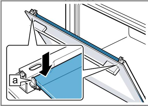
5. Die Gerätetür öffnen und Türdichtung einhängen.
