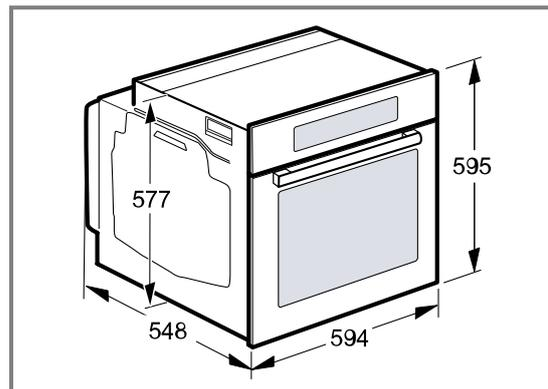
**24.3 Einbau unter einer Arbeitsplatte**
